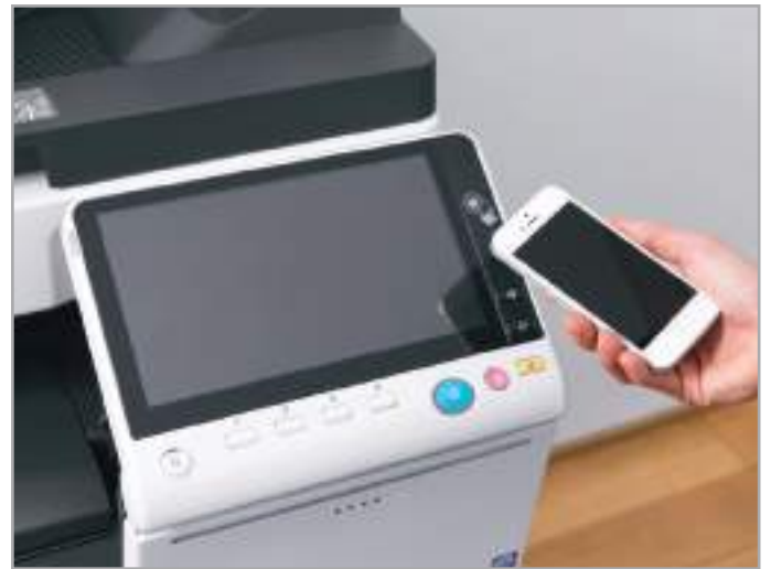
Bedienpanel mit MOBILE TOUCH ZONE und NFC Tag (Near Field Communication) zur Authentifizierung und Kopplung mit mobilen Geräten
